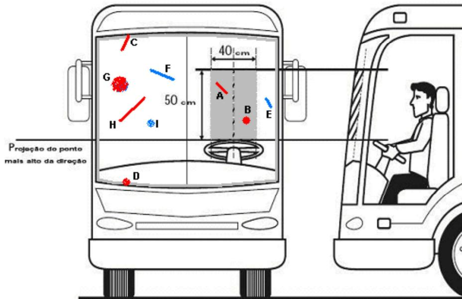
O RETÂNGULO CINZA E A FAIXA CINZA (COM 2,5 cm DE ESPESSURA EM TODA A BORDA DO VIDRO) CORRESPONDEM À ÁREA CRÍTICA DE VISÃO DO CONDUTOR.
